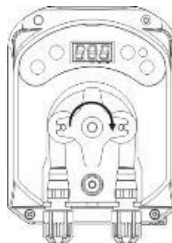
Fase 2 - Rotazione rullino in senso orario e sgancio della ghiera di aspirazione (sx) dalla
