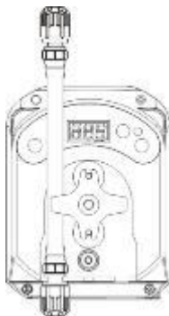
Fase 1 - Posizionare il tubo agganciandolo alla sede di sinistra
